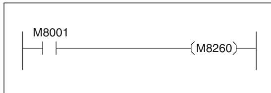
Fig. 10-13 L'unità di misura delle temperature, che il FX3U-4AD-PT-ADP installato come 1° modulo ADP analogico rileva, è regolata su "Gradi Celsius (°C)". La memoria M8001 è sempre "0".
